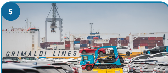
Een Roll-on-roll-off schip (ro-ro) kan auto's en andere voertuigen vervoeren.
